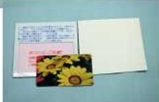
今回は簡易の仮治具のため、強度などの不足により、ラミネーターによっては出来上がったカードのふちの接着が不完全な事があります。貼り付け治具のフタを開けたまま、再度ラミネートをして下さい。
